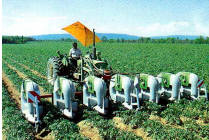
14. ábra: Burgonyabogár gyűjtő gép munka közben
